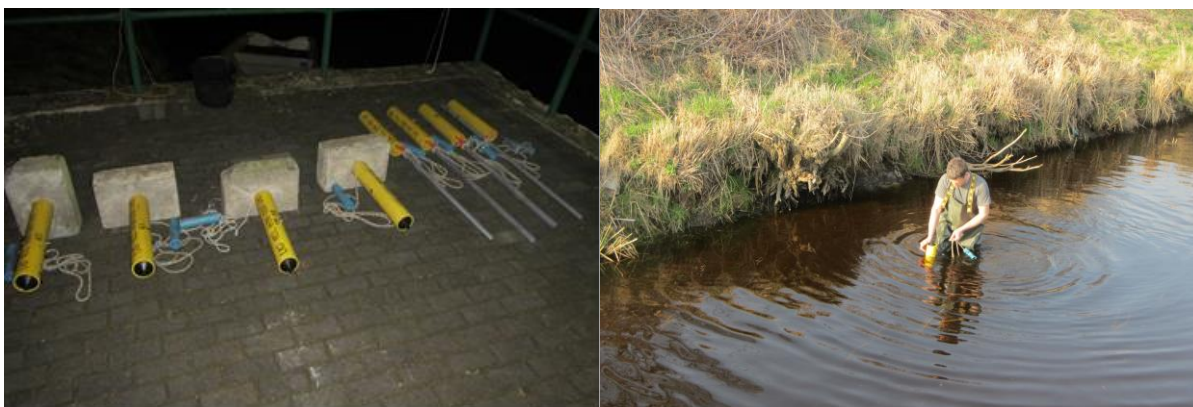
Monitoring migracji szczupaków: z lewej gotowe zestawy kotwiczące, z prawej wystawienia rejestratora w Płutnicy.
